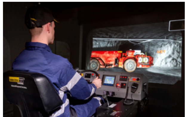
Simulator Truk Bawah Tanah Sandvik TH545i
