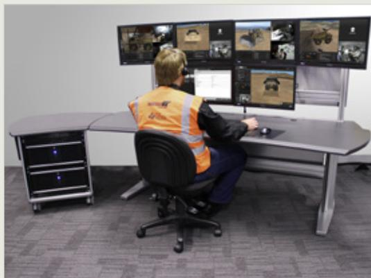
*La Station de Productivité du Formateur : un poste de travail centralisé pouvant se connecter jusqu'à cinq simulateurs de pointe et permettant à un seul formateur de gérer jusqu'à cinq sessions de formation simultanément.*
